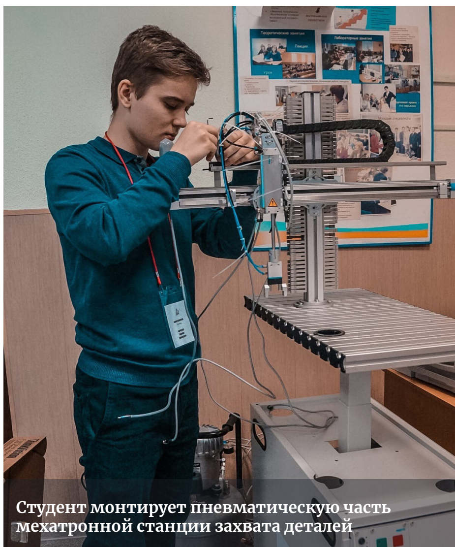
Первая часть задания демонстрационного экзамена — «Сборка и монтаж мехатронной станции» (студенка устанавливает гибкий кабель-канал для подключения устройства захвата и перемещения деталей)
