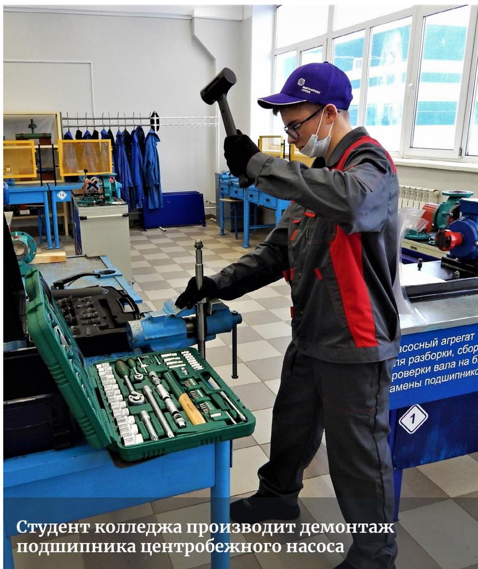
Студент колледжа производит демонтаж подшипника центробежного насоса
